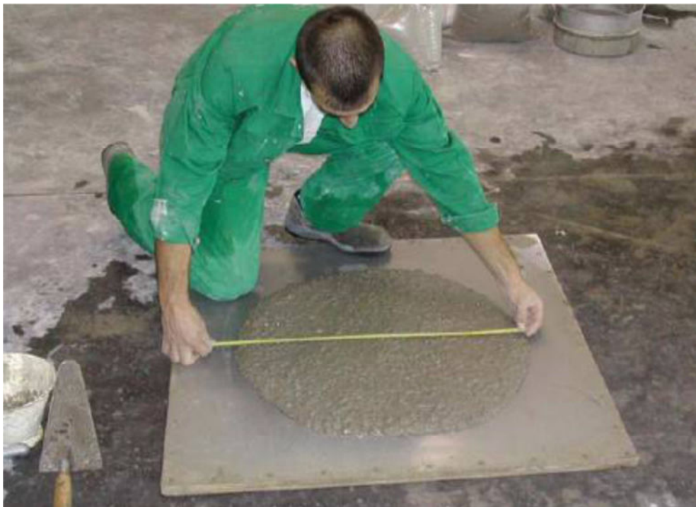
(3) Obr. 3 – Zkouška rozlití SCC - správně navržená směs
